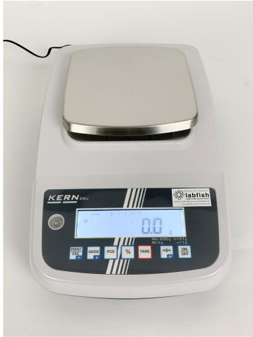
Präzisionswaage Kern EWJ-6000-1M (6000g /
